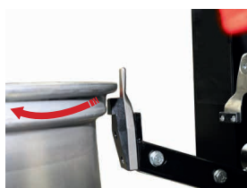
Montaggio tallone inferiore Bottom bead mount
