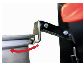
Montaggio tallone superiore Top bead mount
