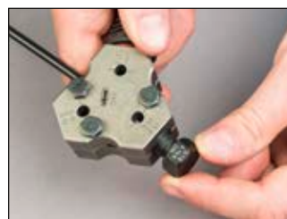
DIN flaring process
