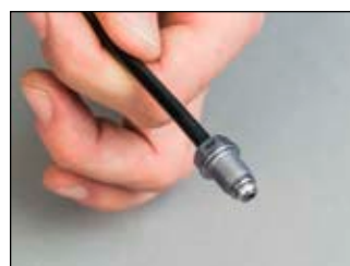
DIN flaring process
